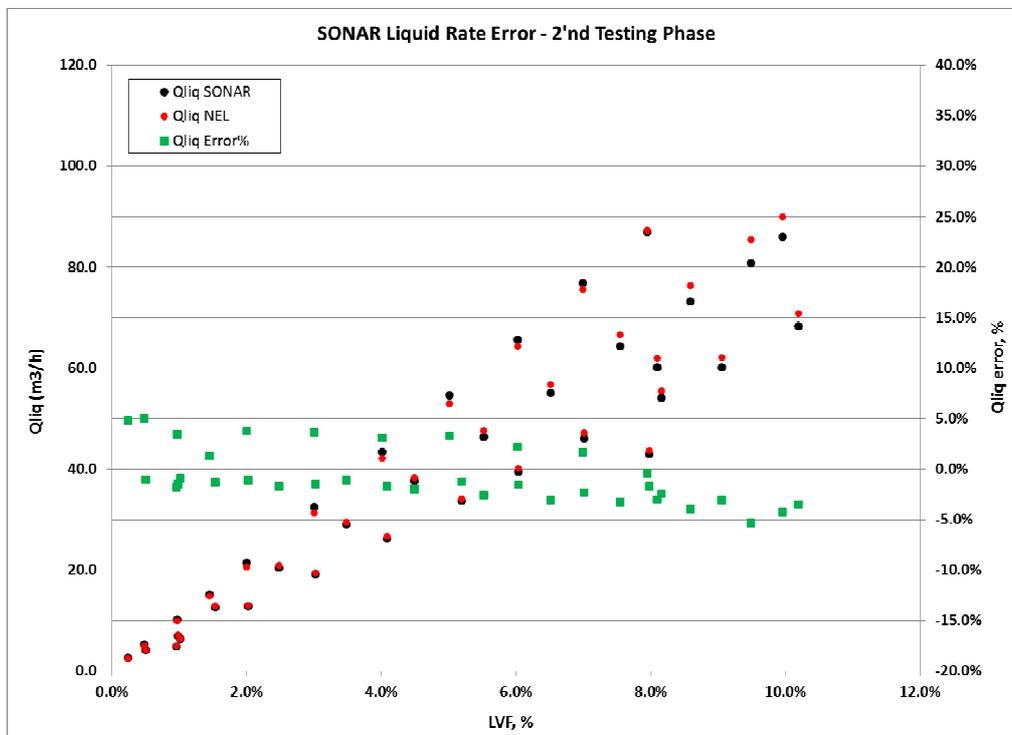
Fig. 9 -  $Q_{liq}$  error versus LVF (2<sup>nd</sup> Testing Phase)
