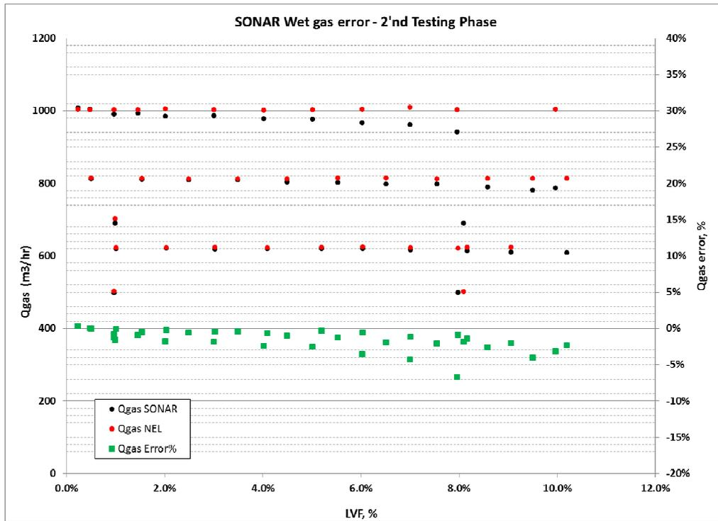
Fig. 8 -  $Q_{gas}$  error versus LVF (2<sup>nd</sup> Testing Phase)
